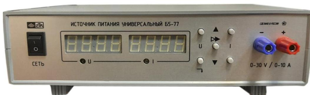
Рис.1 – Внешний вид источника питания универсального Б5-77
