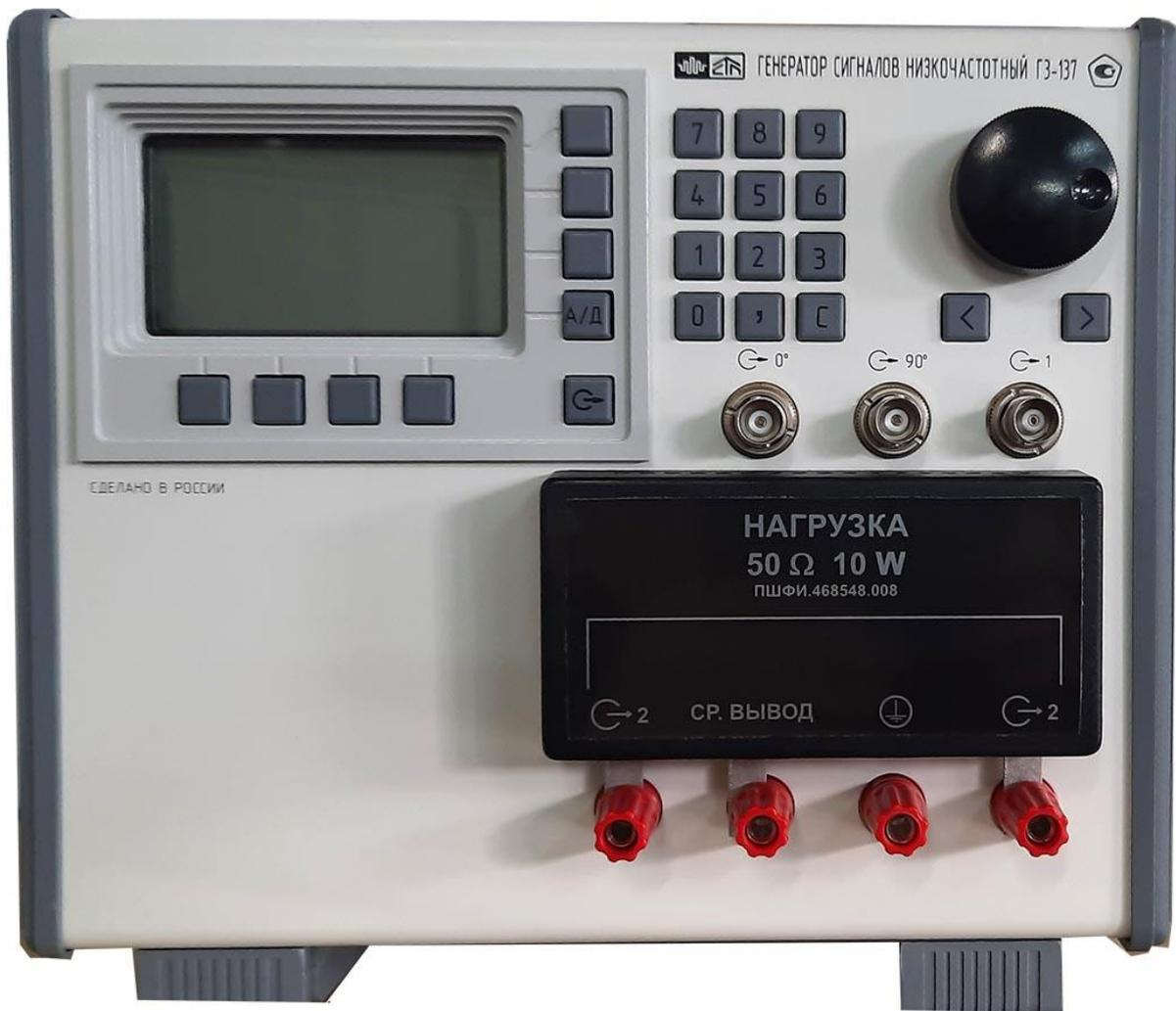
Рисунок 4.1 – Внешний вид генератора сигналов низкочастотного ГЗ-137
