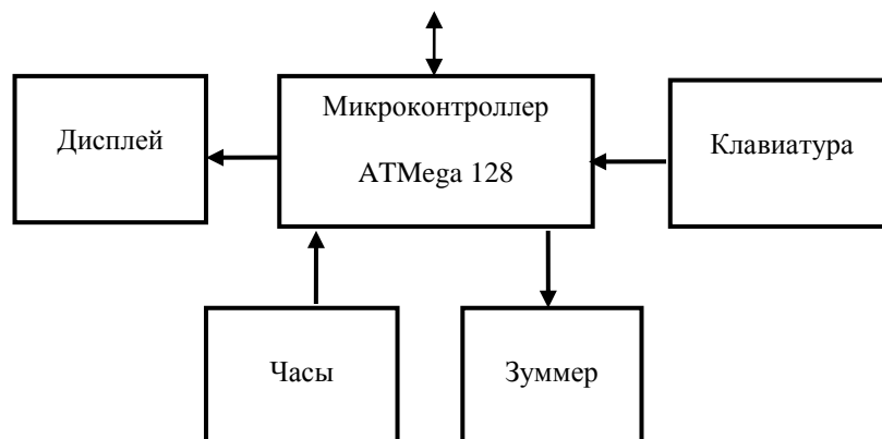
Рисунок 4.12 – Структурная схема блока клавиатуры
