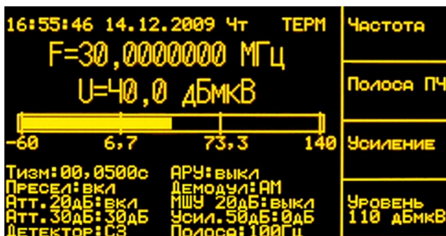
Рисунок 8.1 – Внешний вид экрана вольтметра после стартовой инициализации
